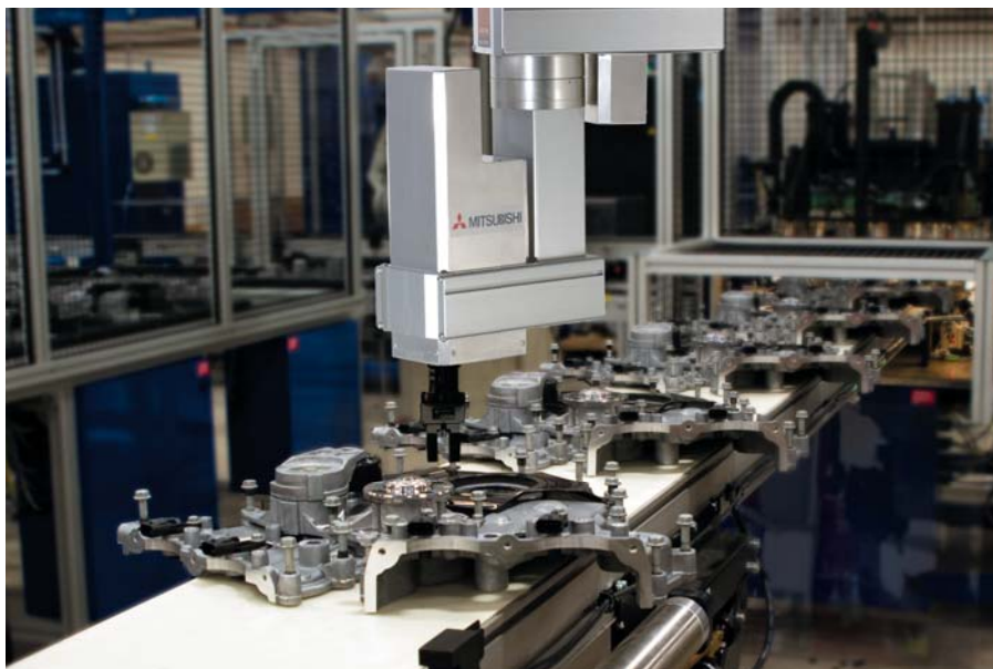
Потолочный монтаж экономит пространство в проблемных и тесных производственных ячейках.
