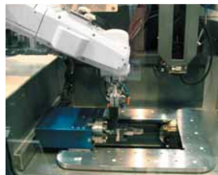
RV-3SB в электроэрозионном станке
